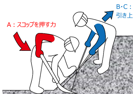
従来の2人スコップ作業 スコップを引き上げる力B+押す力A
