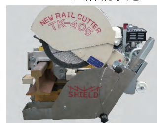
シールド切断時状態
