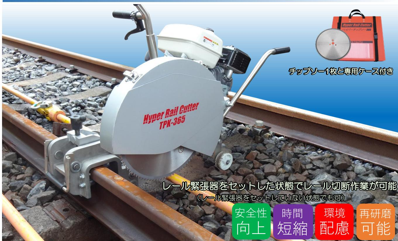
レール緊張器をセットした状態でレール切断作業が可能
